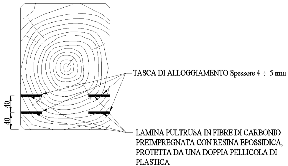
Figura 90. Rinforzo di elemento in legno mediante lamine pultruse inserite in tasche laterali su doppio registro
