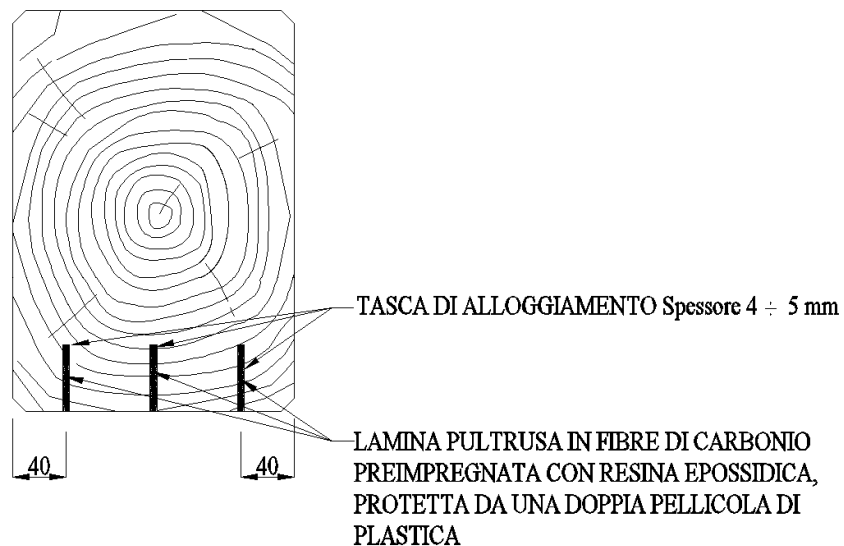
Figura 88. Rinforzo di elemento in legno mediante lamine pultruse inserite di coltello all'intradosso
